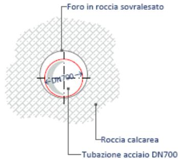
La realizzazione di un microtunnel eviterà dissesti al patrimonio boschivo ma soprattutto al versante molto acclive poiché i previsti sbancamenti per la posa in opera della condotta potrebbero innescare processi deformativi della roccia con conseguenti problematiche di continui scaricamenti e mantenimento di efficienza del tracciato
